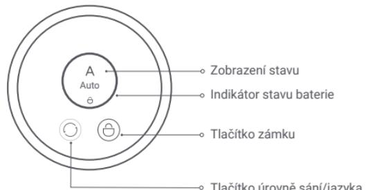
Poznámka: Když vysavač běží na úrovni sání Turbo pomocí štěrbinové hubice nebo kartáčové hubice, indikátor stavu baterie "dýchá" zeleně. To je normální.
