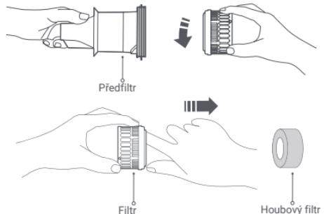
3. Opláchněte nádobku na prach, předfiltr, filtr a houbový filtr pod tekoucí vodou z vodovodu, dokud nebudou čisté, a poté odložte všechny části po dobu nejméně 24 hodin, aby došlo k úplnému vyschnutí.
